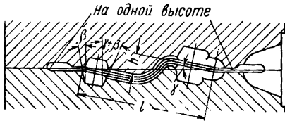
Рис. 57. Наклон фигуры поковки
